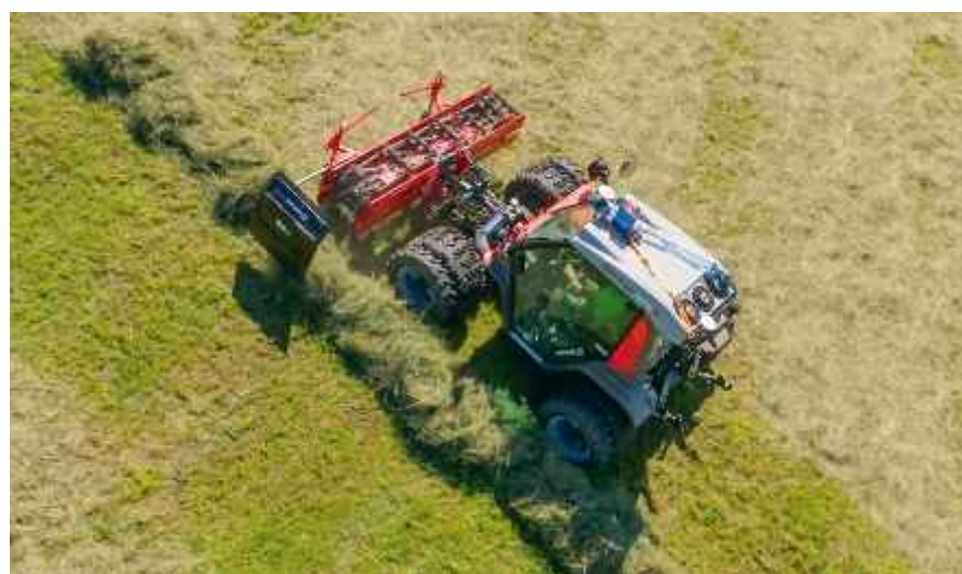
Räumbreite: Mit einem Seitenverschub lässt sich das Überfahren der Schwadkante verhindern.
