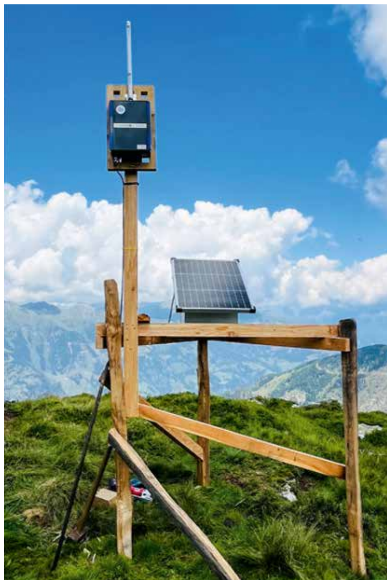
Lokale LoRa-Funk-Antenne mit Solarmodul der Firma Viehfinder auf einer Alm.
