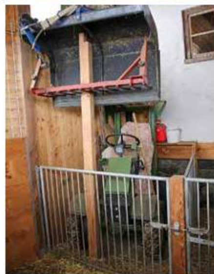
Der Dreirad-Elektro-Hoflader kommt alle zwei Wochen beim Entmisten zum Einsatz und parkt in diesem Stallabteil. Der Mist wird in den Auslauf gekippt, wo er mit einem gebrauchten stationären LKW-Kran zum Misthaufen umgehoben und aufgeschichtet wird. Der fix montierte Kran wird im Herbst auch zum Verladen des Mistes auf den Streuer verwendet.
